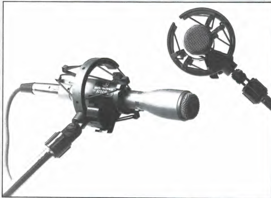
Foto 2. Vloertrillingen die via het microfoonstatief tot de microfoon doordringen zijn funest voor de opname. Gebruik in zo'n geval een verende opstelling, zoals de hier afgebeelde speciale shock mount.
